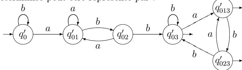
On constate que l'automate obtenu n'est pas minimal, les trois états acceptants pouvant être regroupés en un seul sans modification du langage reconnu, d'où l'automate déterministe plus simple reconnaissant  $\Sigma^*abb\Sigma^*$  :
