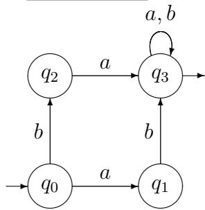
**Notations :** Si  $\delta(q_i, a) = q_j$ , on note encore  $q_i.a = q_j$  et cette transition est représentée par  $q_i \xrightarrow{a} q_j$ .
