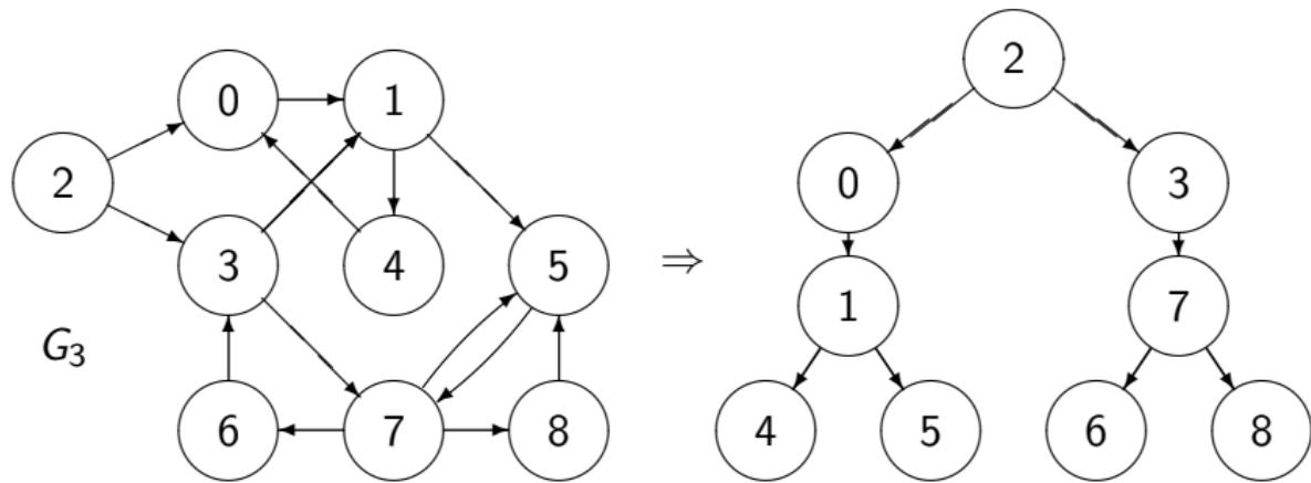
Pour déterminer la distance entre deux sommets d'un graphe non pondéré, il suffit d'effectuer un parcours en largeur à partir de l'un des sommets jusqu'à trouver l'autre.
