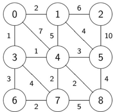
**Exemple :** Pour le graphe ci-dessous, on a représenté l'arbre couvrant minimal obtenu en démarrant avec le sommet 0.
